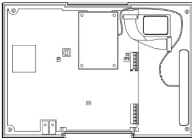
8. Collegare nuovamente la sirena e rispettare la corretta sede del microfono. Rimontare il retro dell'alloggiamento assieme alla copertura frontale.
