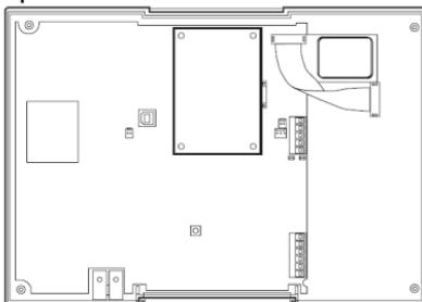
7. Plaats de antennekabel en plak de antenne op een geschikte plaats in de behuizing vast.
