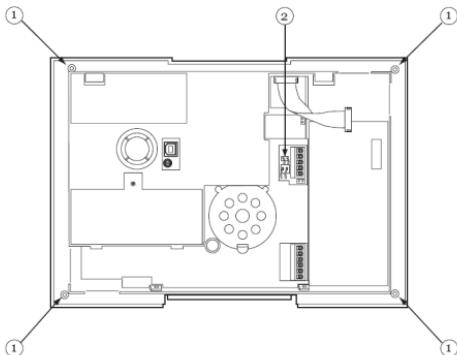
5. Avant de retirer complètement le panneau arrière du boîtier, le soulever légèrement et déconnecter la sirène.
