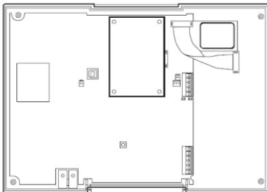
7. Verlegen Sie das Antennenkabel und kleben Sie die Antenne an einen geeigneten Platz im Inneren des Gehäuses fest.
