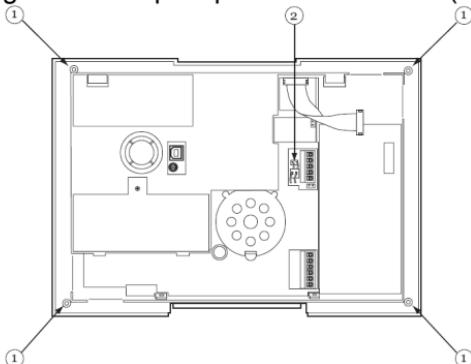
5. Prima di rimuovere completamente il retro dell'alloggiamento, sollevarlo leggermente e staccare il connettore sirena.
