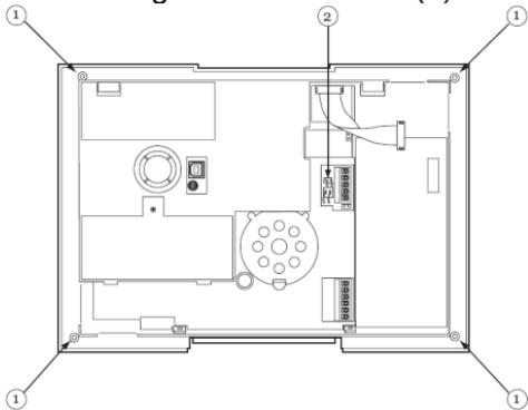
5. Bevor Sie die Gehäuserückwand ganz entfernen, heben Sie diese etwas an und ziehen den Sirenenstecker ab.
