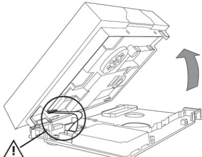
3. Lösen Sie alle vier Schrauben, die das Gehäuse der Zentrale zusammenhalten (1).
