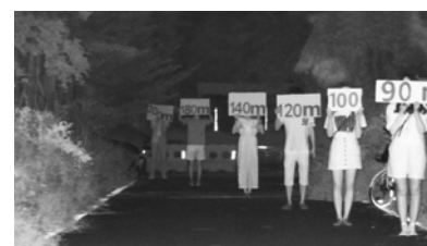
Mehrzonen IR-Beleuchtung mit hoher Reichweite ohne Überblendungen
