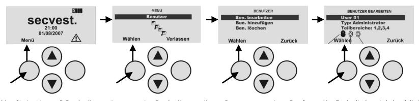
Wählen Sie im Menü z.B.Fernbedienung" aus, um eine Fernbedienung diesem Benutzer zuzuweisen. Der SecvestKey Funkzylinder wird ebenfalls in diesem Menü eingelernt.
