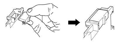
Hängen Sie die Zentrale oben in der Bodenplatte ein und verbinden Sie das Flachbandkabel wieder mit dem Anschluss auf der Bodenplatte. Klappen Sie nun die Front nach unten und befestigen Sie sie mittels der 2 vorhin entfernten Gehäuseschrauben.
