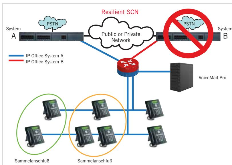
Bei Unternehmen mit mehr als einem Standort stellt IP Office einen kontinuierlichen Betrieb sicher. Während eines Stromausfalls kann für Teilnehmer mit IP Telefonen die automatische Umschaltung auf das System eines anderen Standortes eingerichtet werden, sodass eine unterbrechungsfreie Kommunikation gewährleistet ist. Es besteht auch die Option, das Voice-Mail-System verteilt aufzubauen und als eine Backup-Lösung immer verfügbar zu machen.
