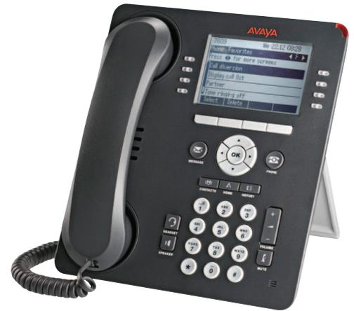
gesamt 96 Funktions- oder Schnellwahltasten, duale rot-grüne LEDs als Statusanzeigen. Bei Integral 5: 8 konfigurierbare Funktionstasten, plus optional bis zu max. 3 Tastenmodule mit je 12 Tasten in 2 Ebenen, einsetzbar als Funktions- oder Schnellwahltasten, duale rot-grüne LEDs als Statusanzeigen
